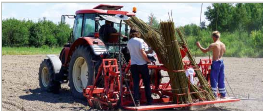
Sadzenie sztabrów wykonywane przez firmę usługową z wydajnością jednego hektara na godzinę
